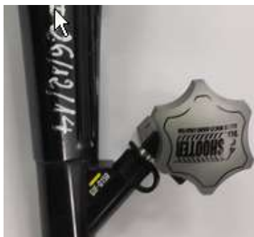
Hình 2.36. Lắp tay quay
