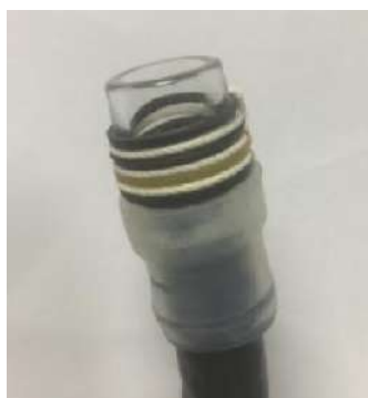
Hình 2.40. Lắp đầu bắn
