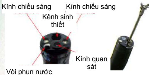
Hình 1.4. Cấu tạo đầu máy nội soi
